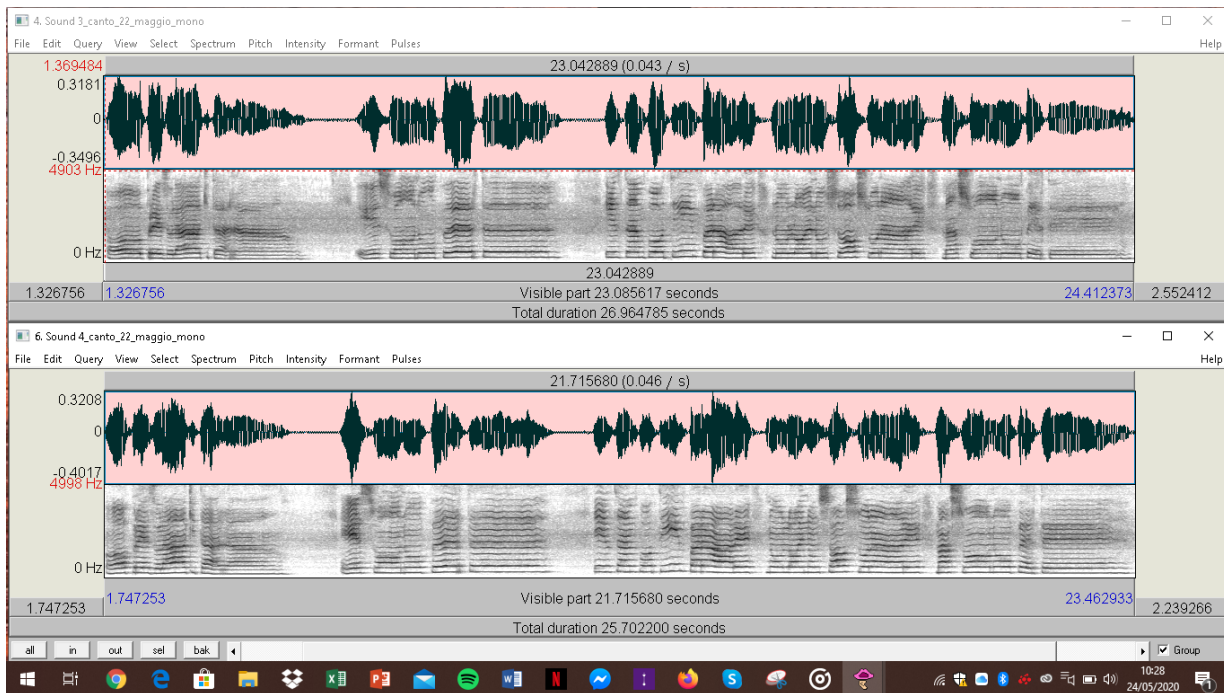
Immagine 12. Analisi della voce. Spettro prima (sopra) e dopo il trattamento (sotto). Programma PRAAT
